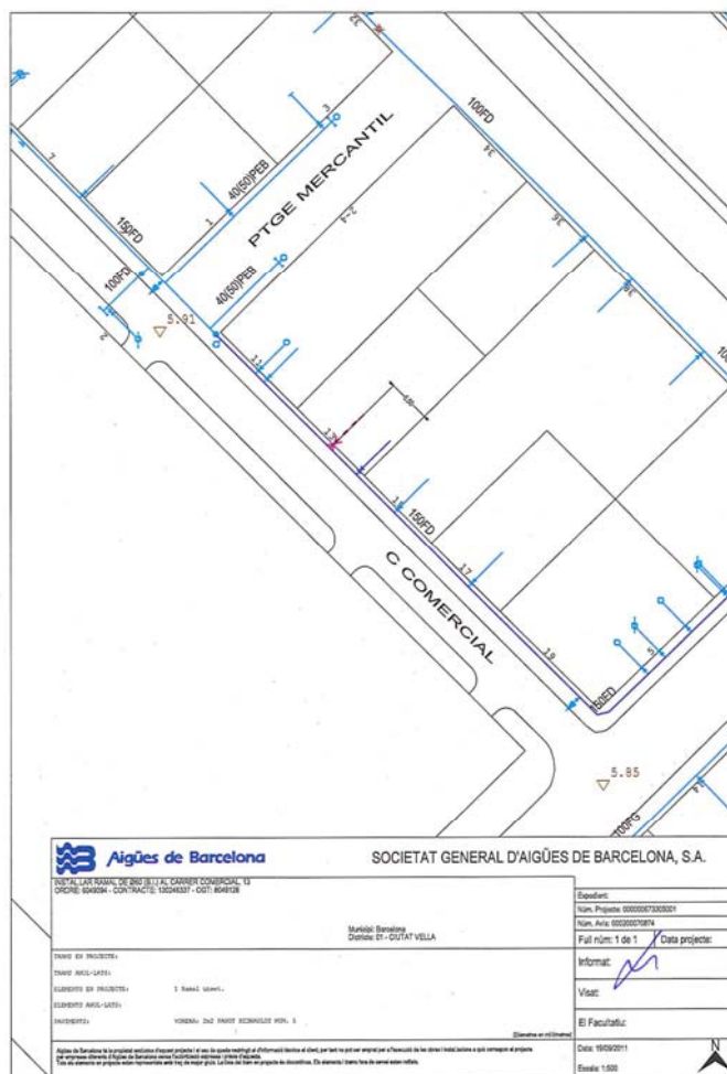
Projecte d'instal·lació d'escomesa d'aigua (Aigües de Barcelona)
